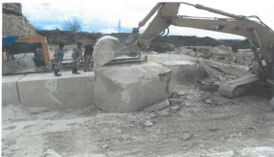
Slika 25. Odvajanje bloka od stijenske mase pomoću bagera
