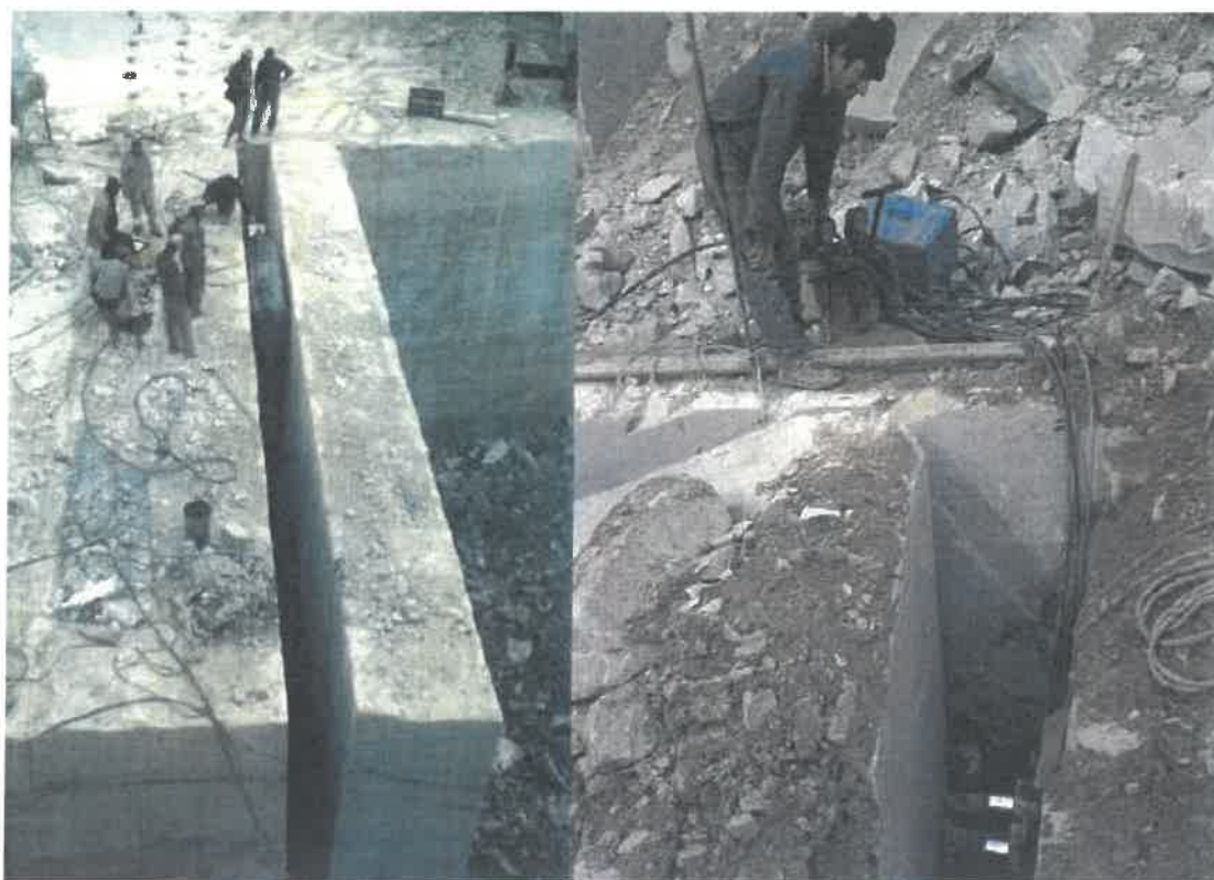
Slika 20. Razmicanje kamenih blokova pomoću zračnih jastuka
