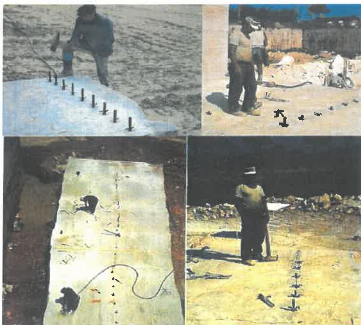
Slika 18. Rad pri dobivanju kamenih blokova cijepanjem klinova
